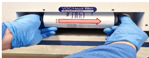
12.2 ábra A VOC/HEPA-szűrő behelyezése és eltávolítása
