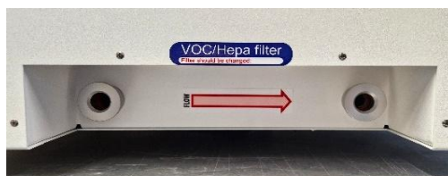
12.1 ábra Az áramlási irányt jelölő nyíl a Mini MIRI® száraz többkamrás IVF-inkubátoron
