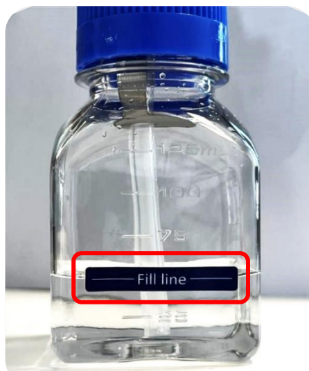
22.2. ábra Feltöltést jelző vonal a párasító palackon
