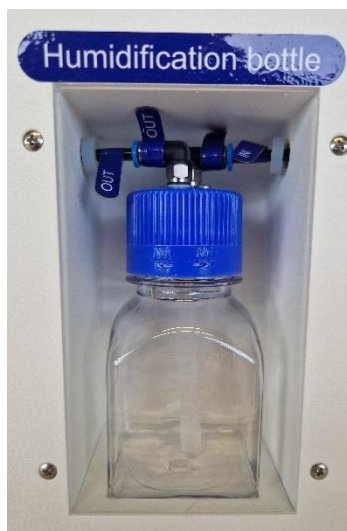
22.1. ábra Csőcsatlakozás a párasító palackon és a Mini MIRI® párasított többkamrás IVF-inkubátoron
